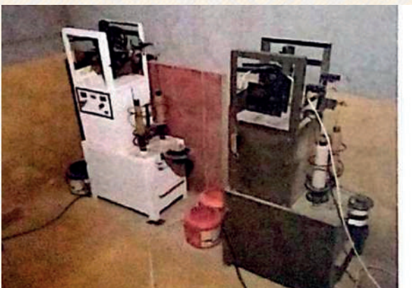
Máquina artesanal para el torcelado de l fibra de vicuña
